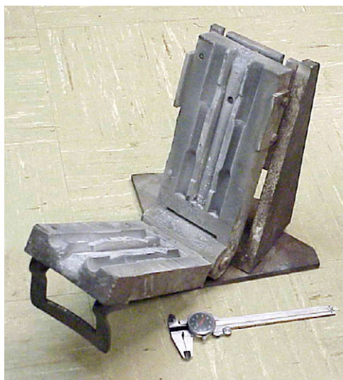
Fig. 2. The test bar mold.
